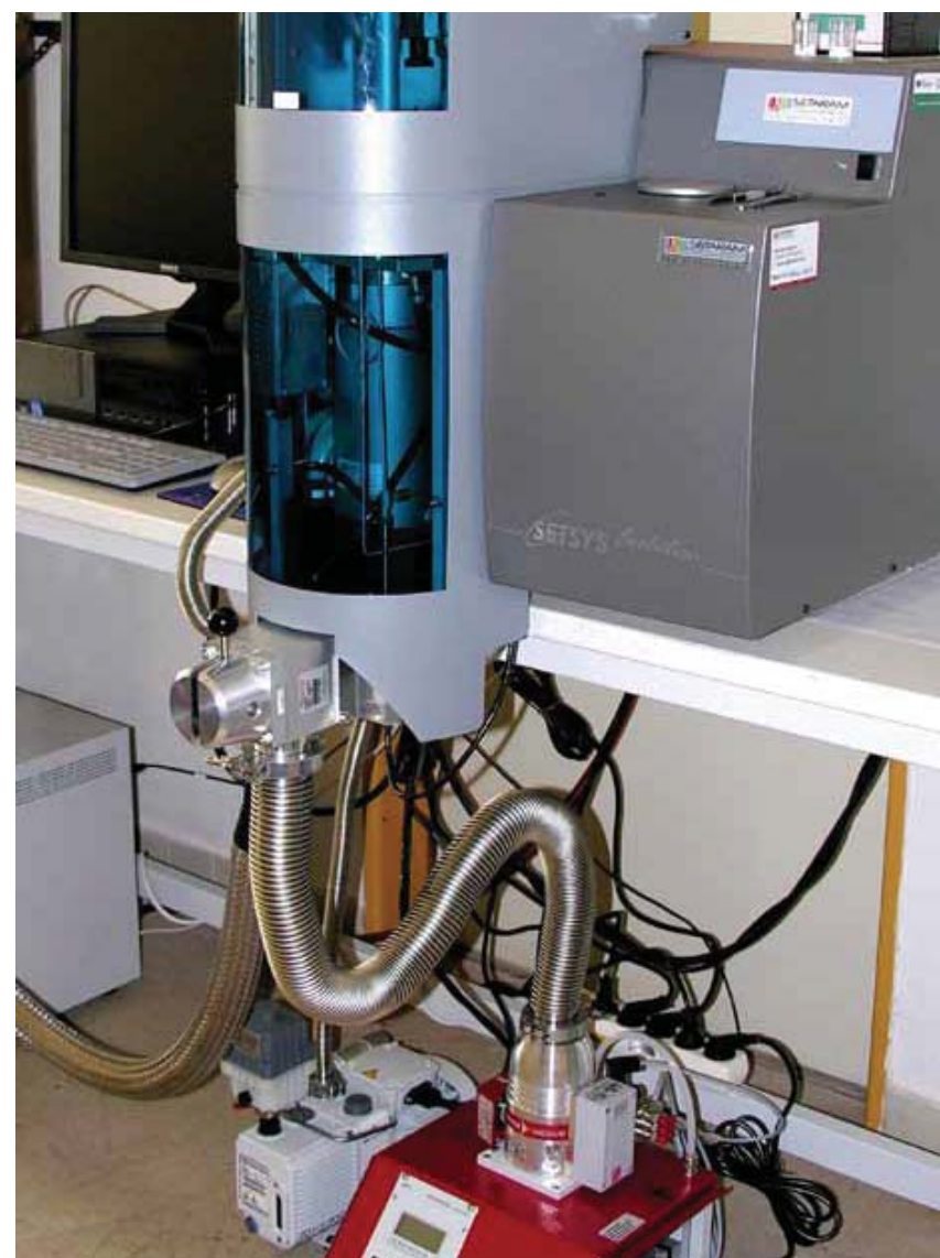
Termální analyzátor SETSYS TG-DTA/DSC 24 s hmotovým spektrometrem (Setaram Instrumentation)
