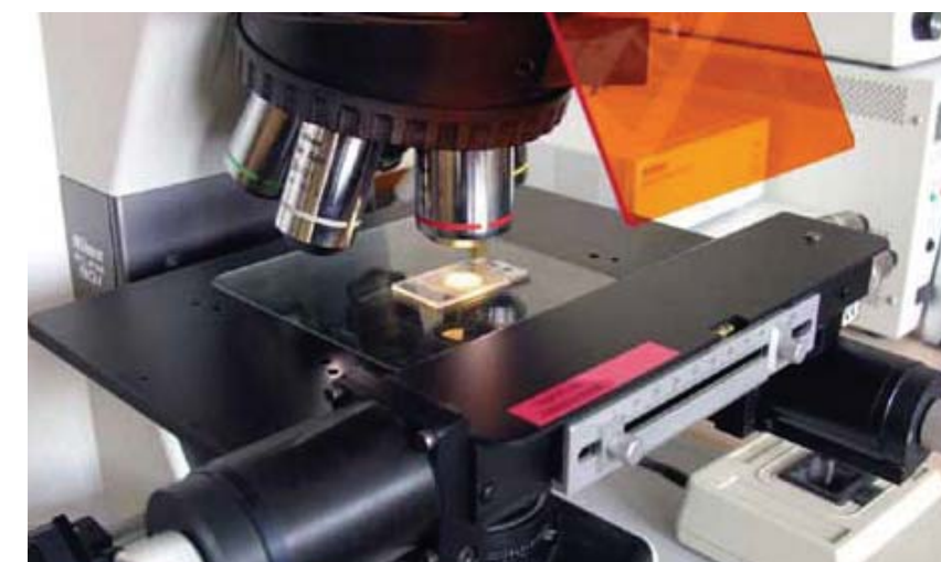
Mikroskopický preparát (horninový výbrus) v procházejícím světle optického mikroskopu NIKON Eclipse 80i
